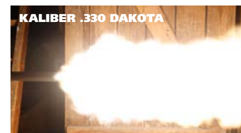
KALIBER .330 DAKOTA ALM IMS N2: Dette var en overraskelse – og høyst interessant. Jeg veit rett og slett ikke hvorfor denne voldsomme flammen oppstår i akkurat denne demperen.
