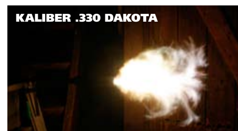
KALIBER .330 DAKOTA ALM IMS N1, .330 DAKOTA: En betydelig demping av flammen, selv om det ennå er en del igjen. Faktisk mer enn en udempet 6,5x55.
